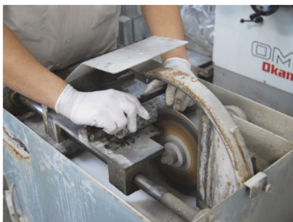
コアカッターによる供試体の切断
