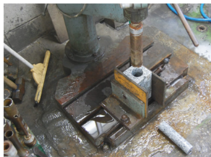
コアリングによる供試体抜き出し
